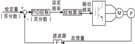
图 6-20 过程 PID 原理框图
