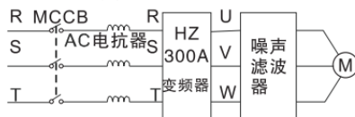
图 4-23 主回路电机侧连接图
